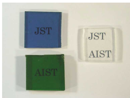
図1 廃着色ガラスとそれを処理して得られた多孔質シリカ
