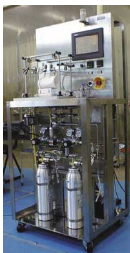
写真1 今回開発した実用機「自動化された超偏極キセノンガス製造装置」
