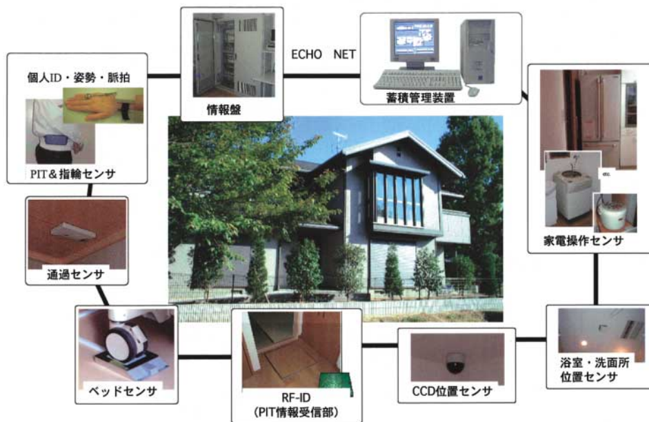
●写真3：住宅内行動常時計測のための実験住宅と設置されたセンサ類
