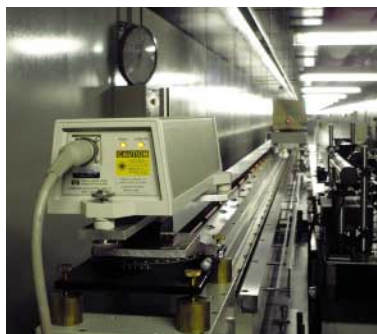
●写真2: 距離計校正用レーザ干渉計(光学トンネル入り口付近)
