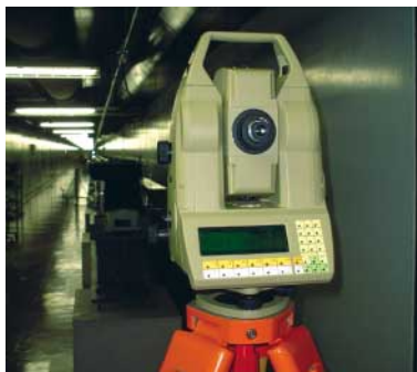
●写真1: 校正のため光学トンネル100m付近に設置した光波距離計
