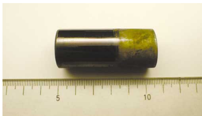
写真2 腐食試験後の酸化チタンコーティング鉄管
