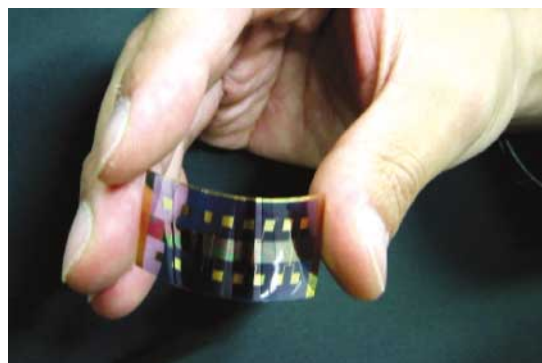
写真 プラスチックフィルム上に作製した有機薄膜トランジスタ
