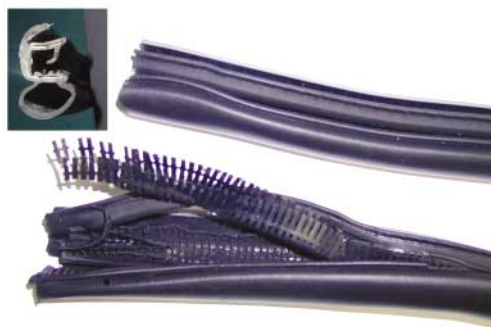
写真2 分離した窓ガラスシール複合材
