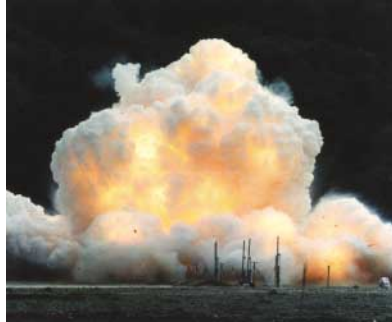
●写真上：黒色火薬100kgの爆発実験（1991年、当時の環境立地局と共催実験） ●写真右：写真上のような大量爆発を模擬する微量爆発実験（衝撃波の伝播の様子がよくわかる）
