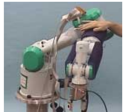
写真2 (右) 触覚を用いた接触回避動作(上下)
