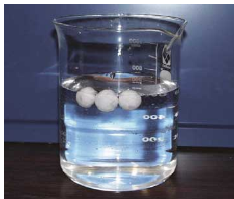
写真 水面に浮遊する水質浄化触媒
