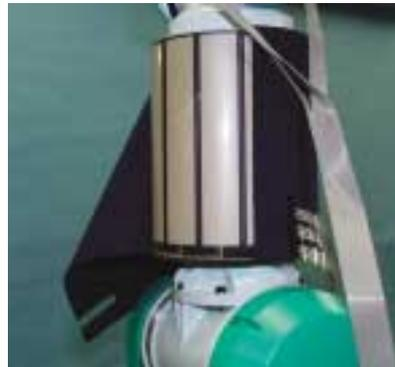
写真1 (上) 第4リンクの外皮とセンサシート
