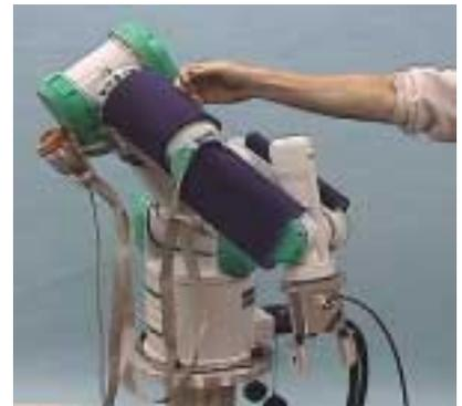
写真2 (右) 触覚を用いた接触回避動作(上下)
