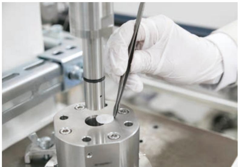
▲プレス機に布をセットしてプレスすると、二酸化炭素が液化して、材料が柔らかくなり接合する。その後、排気をするため完成した多孔体には二酸化炭素が残らない仕組み。
