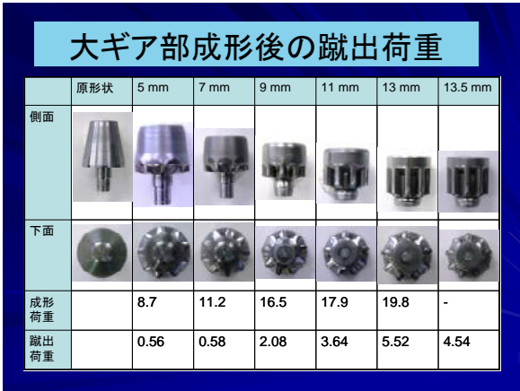
図7 ダブルギアの実験結果
