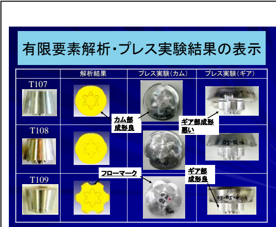
図6 複合ギアの実験結果
