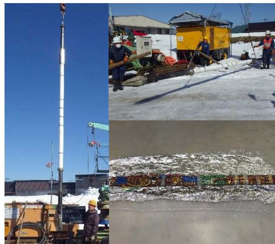
平成26年度に開発したプロトタイプツール。これにより本技術シースの妥当性が示された。27年度は実地熱井内での使用を可能にするために耐高温化改良（200℃、数時間）を行い、実地熱井内での試験を実施し、実用化へ結びつける。
