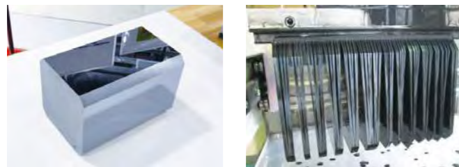
シリコンインゴット(左)と、スライス後の様子(右) (ウェハ厚さは0.12mm)
