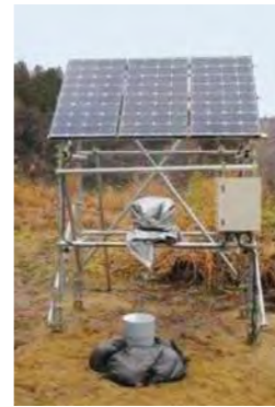
柳津西山地熱発電所 (写真提供:東北電力株式会社) 地表設置型 3成分地震計の設置状況
