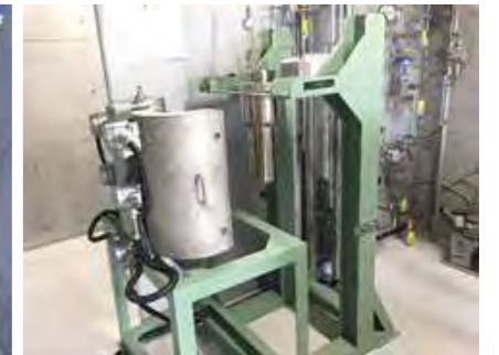
100MPa耐圧・200℃耐熱反応容器
