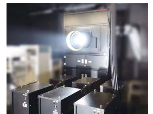
図1 太陽電池モジュールの性能測定用ソーラシミュレータ(擬似太陽光源)
