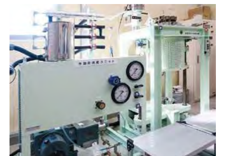
超高温坑内模擬装置 350℃、600気圧の坑内環境を模擬可能な装置です。機器、素材の開発に使用します。
