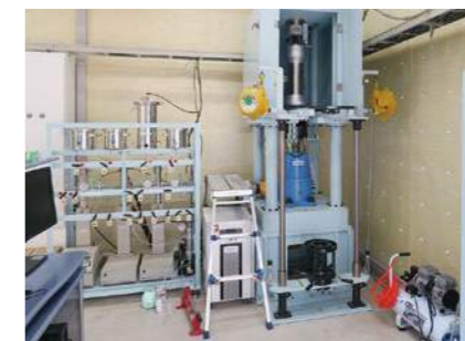
亀裂せん断滑り実験装置 高温・高圧の地熱貯留層内で発生する力学現象を模擬可能な装置です。
