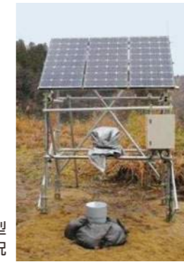
地表設置型 3成分地震計の設置状況
