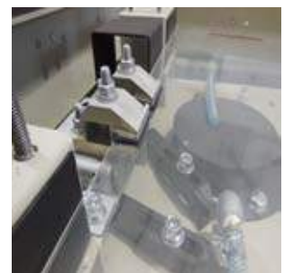
新規に設計したモジュール取付け金具
