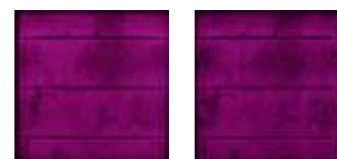
PCT(高度加速)試験前(左)、試験後(右)のEL写真。劣化は観測されていない。
